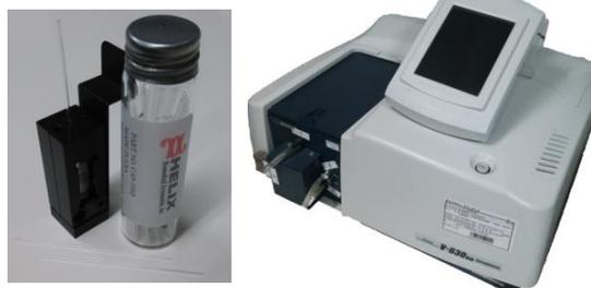
図 1 キャピラリーセルと UV 分光装置
