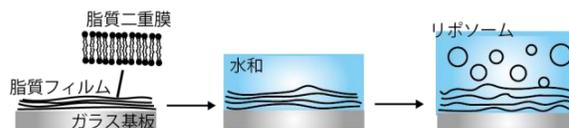
図 2. 静置水和法による GUV 作製
