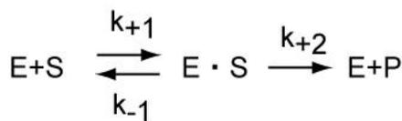
ここで、前半の  $E+S \rightleftharpoons ES$  の反応はすぐに化学平衡に達すると仮定すると、後半の  $ES \rightarrow E+P$  の反応が律速段階と考える事ができる。そこで、解離定数を  $K_s(=[E][S]/[ES])$  式①)とし、全酵素濃度  $[E]_0$  を  $[E]_0=[E]+[ES]$ (式②)とし、式②を式①に代入すると、以下の式を得る。
