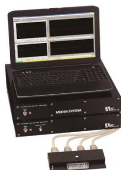
MED64システムは、ガラス基板の上にパターンニングされた64個の平面微小電極（MEDプローブ）上に組織切片を載せる（または細胞を直接培養する）だけで、細胞外電位を64点から同時測定できます。また、任意の電極から電気刺激を与えて、細胞の誘発応答も測定できます。
