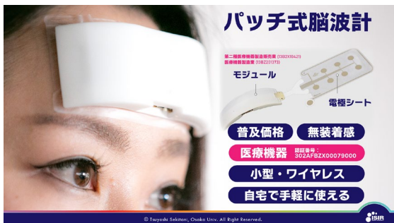
図1：パッチ式脳波計の特徴
